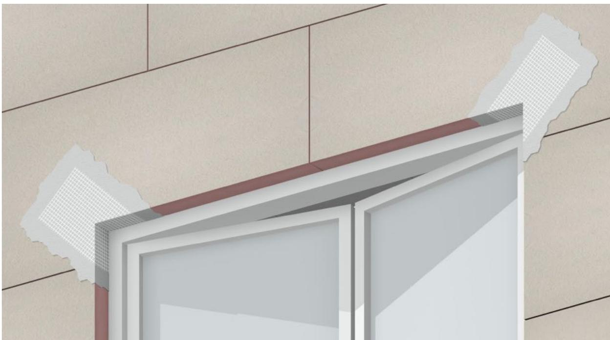
Agli angoli di porte e finestre è necessario inserire reti di armatura diagonali, da applicare nell'intonaco di fondo prima della rasatura armata e da fissare in modo che i bordi delle strisce si trovino direttamente sull'angolo con inclinazioni di circa 45°.
